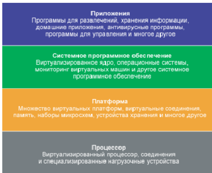
Рисунок 1. Виртуализация применяется на каждом уровне вычислительной платформы
