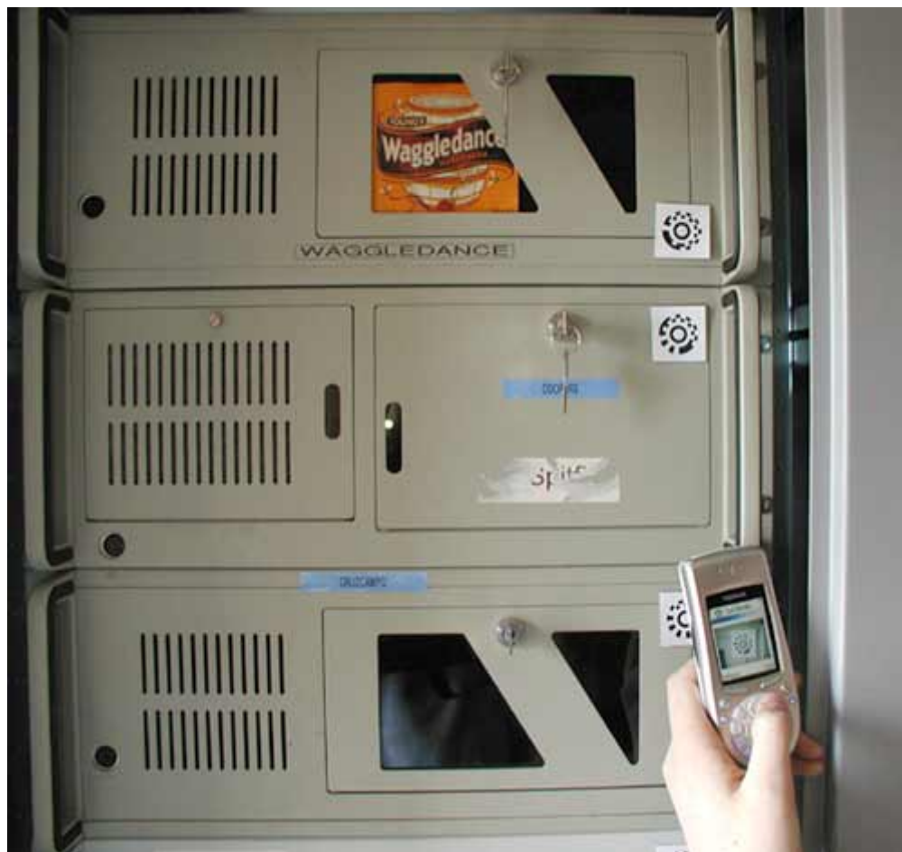
Рисунок 2. Мобильные телефоны со встроенной камерой позволят системным администраторам быстро узнать подробности конфигурации сервера.
