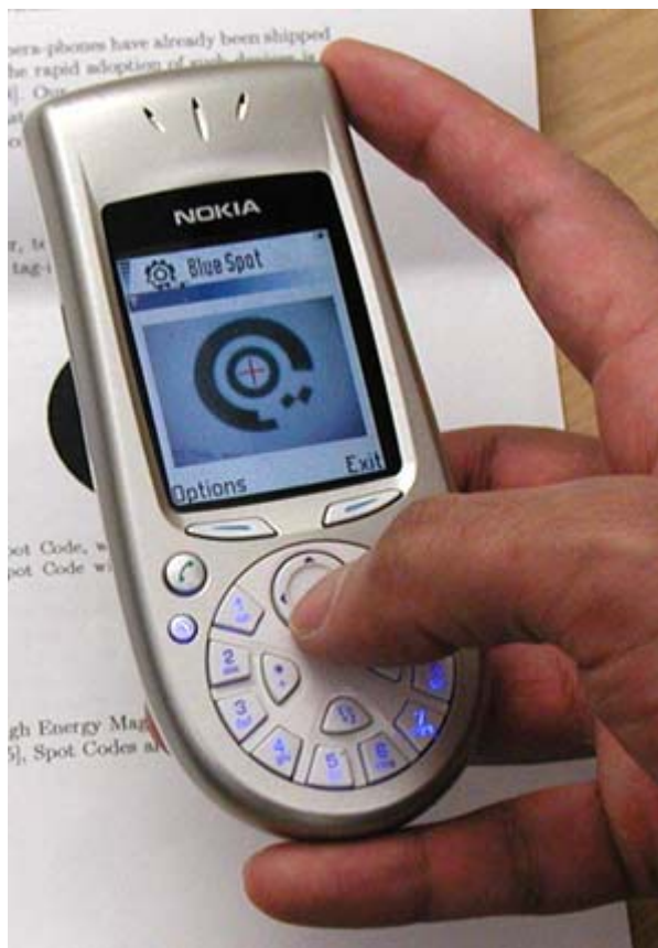
Рисунок 1. Так выглядит устройство для считывания меток (tag-reader) на базе телефона со встроенной камерой.
